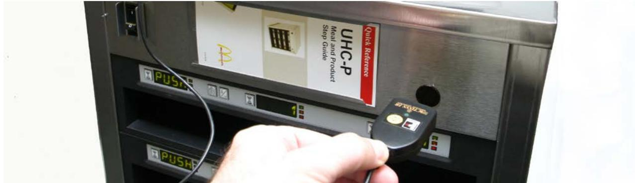
1 将 IR 设备拿到保温柜透镜（前面板右侧的黑色圆圈）前。
